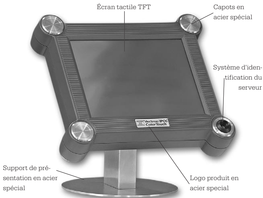
Fig. 15: Le Vectron POS ColorTouch « Special Edition » avec son support de présentation à disposer sur une table
